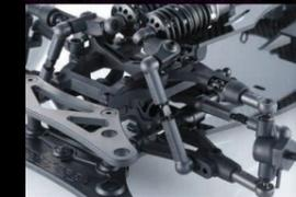
正確な車高調整を可能にするターンバックルタイプのプッシュロッドを採用。
