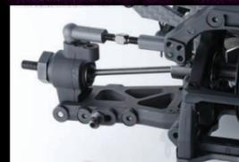
トラクション性能とドリフトコントロール性を大幅に向上させるリヤサスペンション。約4mmショート化されたサスアームにより深いアングルに於いても強力なトラクションを発生し速いドリフトが可能です。
