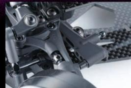
湾曲スライドレールは実績のあるアルミ製オプションと同じ曲率半径を採用。最適なアッカマン比に設定されています。
