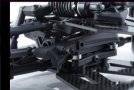
スライドベースは専用設計。樹脂製ながらクリアランス調整機能を持たせることでガタの少ないスムーズな動きを実現します。
